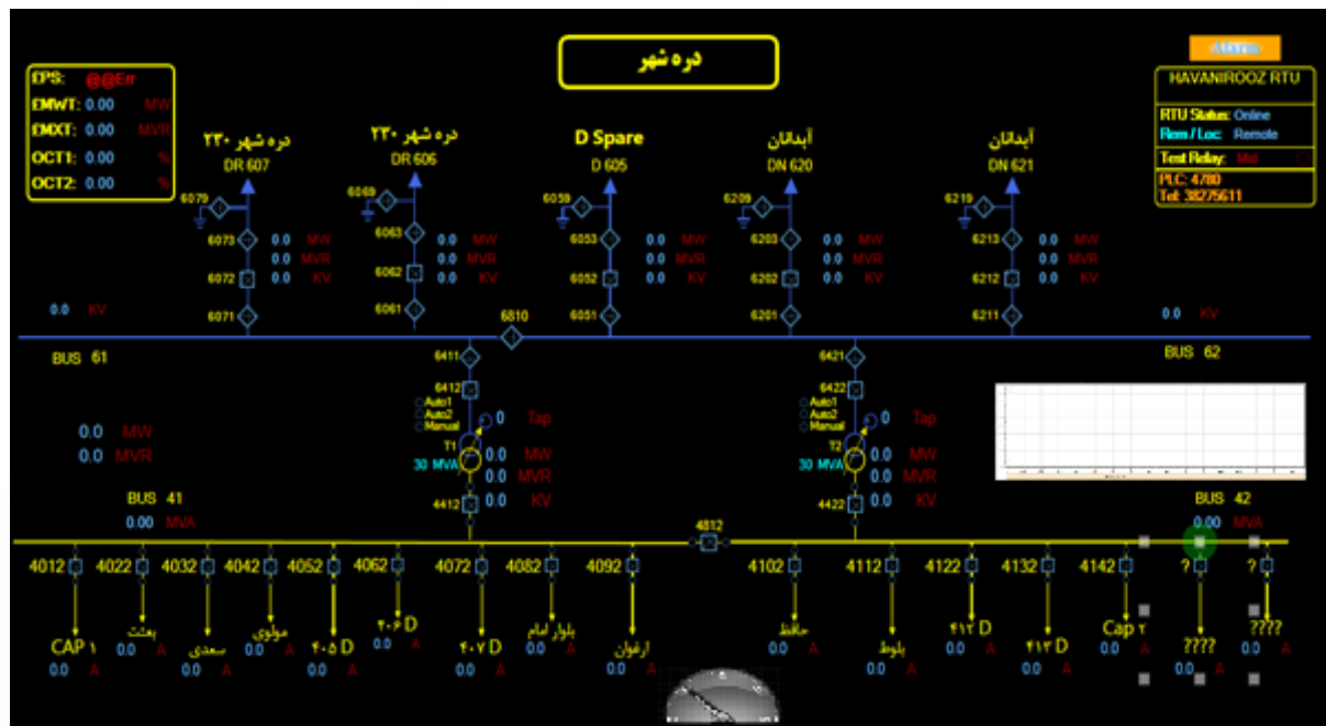
شکل ۱-۱- نمونه‌ای از نمودار تک خطی (SLD) در یک پست ۲۰/۶۳ کیلو ولت
